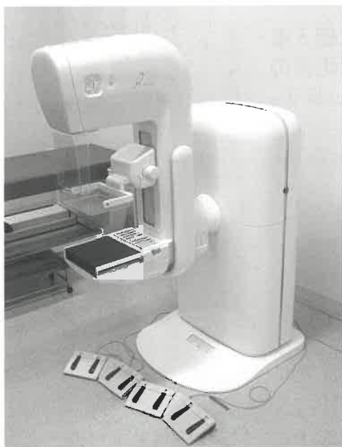
照射野に不具合が発生し、基盤の交換が必要となった乳房X線撮影装置
